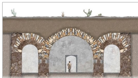
Fig. 8- Representación gráfica de la sección transversal del almacén de pólvora en baluarte vacío poniente (elaboración gráfica por Rogelio Salazar para G. Martínez, 2024).
