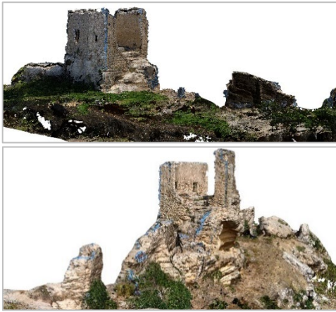
Fig. 11, 12- Castellaccio di Camastra, nuvola di punti densa dei prospetti est ed ovest (elaborazione di Tito Vaccaro, 2024).
