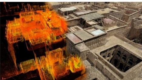
Fig. 6- Banca dati 3D, l'acquisizione multiscale ha reso possibile la comprensione morfometrica delle complessità architettoniche del villaggio e in particolare della Kasbah (elaborazione degli autori, 2024).
