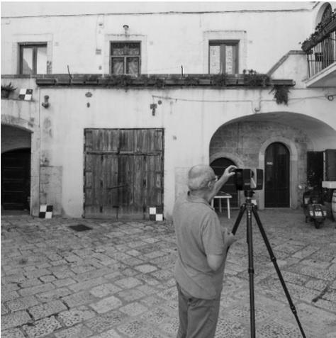
Fig. 9- Operazioni di rilievo laser scanner (foto dell'autore, 2024).
