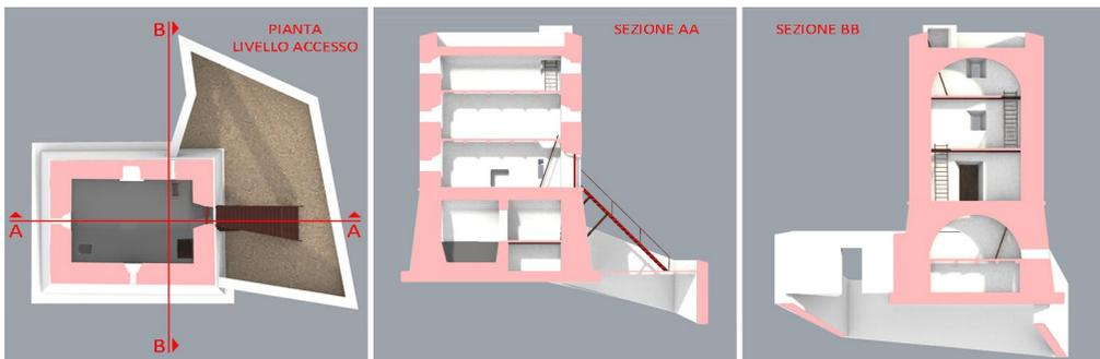
Fig. 6- Modello di ricostruzione della Torre di Cala Moresca (elaborazione grafica di F. Lanfranchi, 2024).
