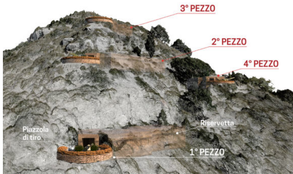
Fig. 8- Ricostruzione virtuale complessiva della batteria di Capo Poro su modello numerico tridimensionale derivante da aerofotogrammetria da drone. Nell'immagine sono visibili le piazzole di tiro con i cannoni e le riservette (in trasparenza) in parte interrate (elaborazione grafica di Alexandra Fusinetti)
