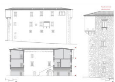
Fig. 8- Palazzo Santucci. Prospetto nord-ovest, sezione e particolare garitta
