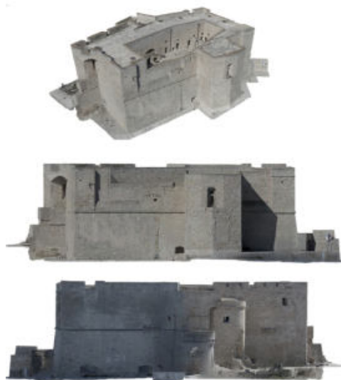
Fig. 8- Monopoli, Castello Carlo V. Rilievo fotogrammetrico, assonometria, prospetto nord-est, Prospetto sud-ovest (elaborazione grafica di G. Colapietro, 2020)
